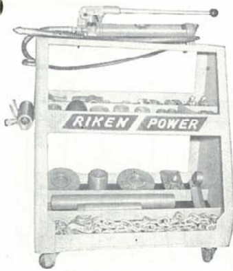
自動車等のシャーシの矯正作業, P-1B, H-2, R-2, R-209, R-212, 他使用。
