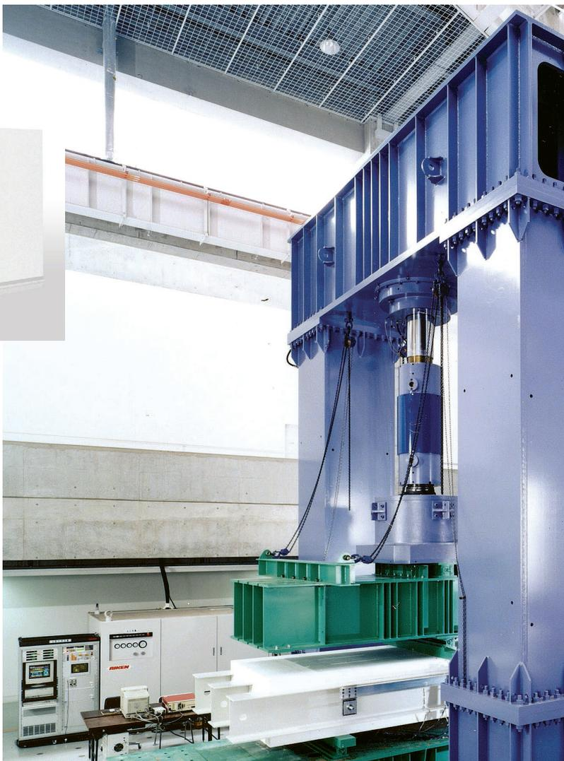
H 型鋼の加力試験装置
