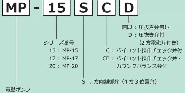
大型積層弁 (電磁弁)
